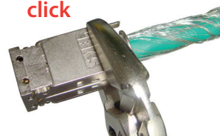
Deckel zusammendrücken, mit Parallelverpresszange (409-5421) bis zum Einrasten verpressen
