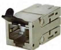
Module de raccordement selon EIA/TIA 568-C.2 pour les applications 10 Gb Ethernet, 500 MHz pour le montage sur fils rigides AWG 23 et AWG 22
