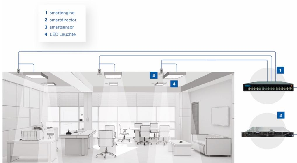
Figure 1 : topologie de la solution « Digital Light » de BKS
