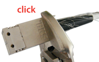
Deckel zusammendrücken, mit Parallelver- presszange (409-5421) bis zum Einrasten verpressen
