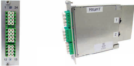
863-10713 | Kompaktmodul 1/2HE Typ «B», 1x MPOF (12) LL - 12x LC / APC, SM, OS2
